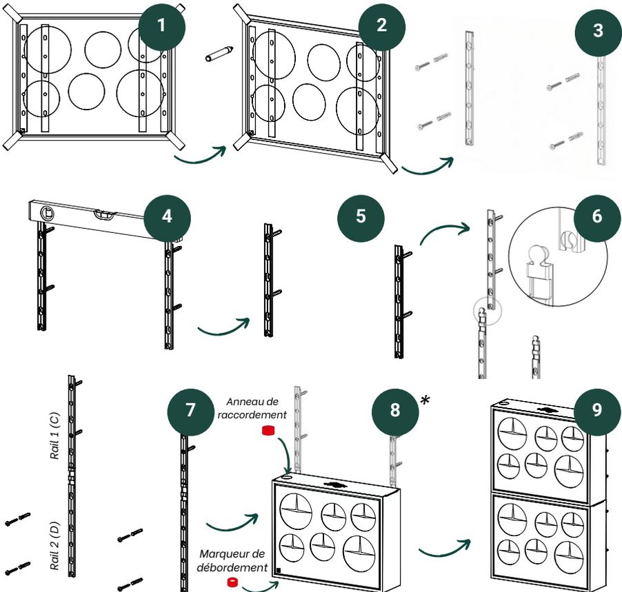
\*Il faut toujours insérer l'anneau de raccordement dans l'orifice d'écoulement de la boîte inférieure et insérer le marqueur de débordement dans le réservoir d'eau.
